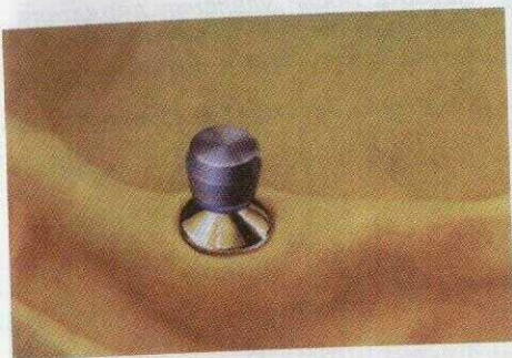
№107-3 Контейнер с матрицей накладывается на сферу до упора с шайбой.
