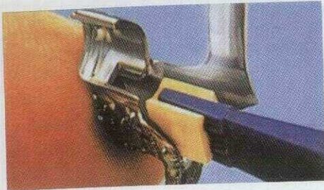
№75-14 Пластиковым ключом матрица устанавливается в свое гнездо. Он изготовлен из беззольной пластмассы, что позволяет отлить его из металла для увеличения срока пользования.
