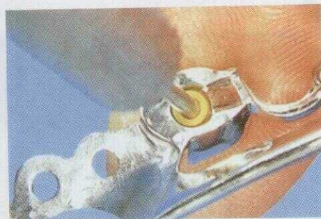
№94-12 Матрица ключом вставляется в гнездо с усилием. После чего она надежно фиксируется в этом гнезде.
