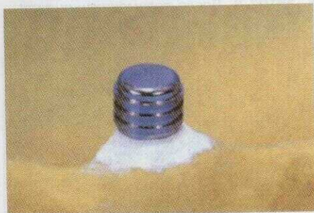
№108-5 Площадка, сформированная из гипса, является ориентиром для правильного расположения контейнера в случае снятия его с матрицы.
