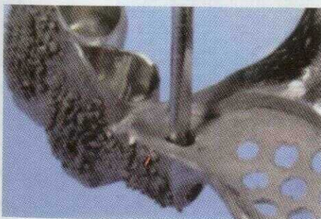
№138-6 После отливки керамическая конструкция выбивается из металла. Отверстия обрабатываются. Дистальное – для вставки силиконовой матрицы, а нижнее – для винта.
