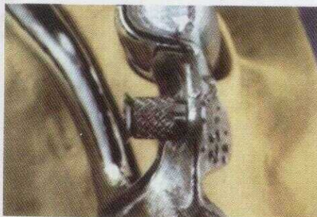
№133-13 Для проверки соответствия отверстий штифт с втулкой вставляют на свое место.
