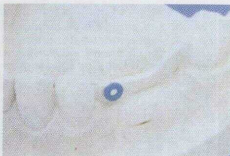
№128-6 Восковая шайба устанавливается на штифт-вставку в огнеупорной модели и приклеивается воском для предотвращения смещения.
