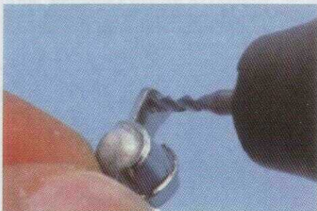
№133-3 Мультидрилем создают отверстие в области углубления с применением масла для фрезерования.
