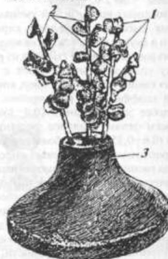
Рис. 285. Детали для отливки зубов: 1 — восковая модель зубов; 2 — литники; 3 — подставка с конусом.
