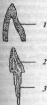
Рис. 246. Протез для замещения полного или субтотального дефекта коронки зуба: 1 — наружная коронка, покрывающая искусственную культию; 2 — искусственная литая культия; 3 — корневой штифт, жестко соединенный с культей.
