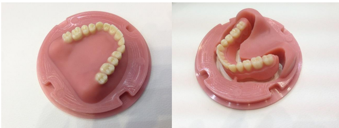
Рис. 64. Протезы после шлифования на фрезеровочном станке перед шлифовкой и полировкой вручную
