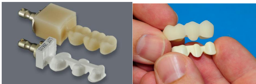
Рис. 38. Отфрезерованные обе части (каркас и облицовка) мостовидного протеза по методике Multilayer, извлеченные из аппарата (а) и после срезания коннекторов (б)
