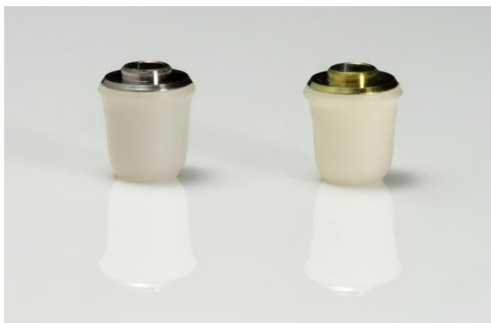
Рис. 66. Перекрытие серого оттенка от металла за счёт анодирования верхнего слоя титана.
