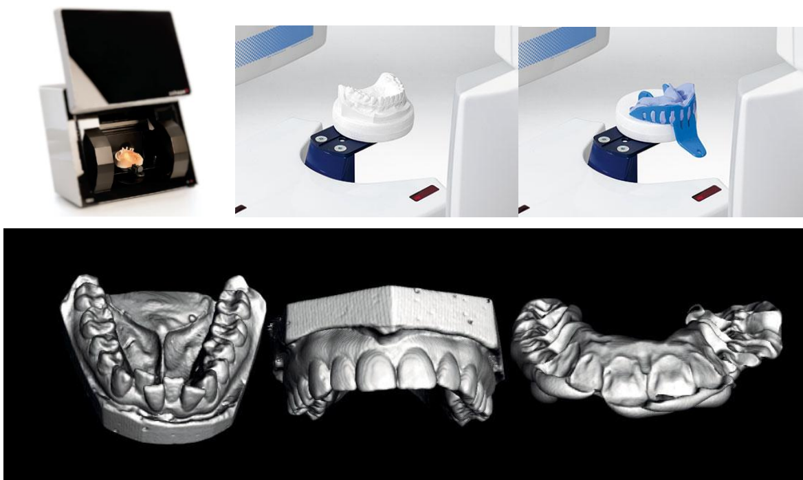
Рис. 30. Сканирование гипсовой модели или силиконового оттиска в лабораторном сканере
